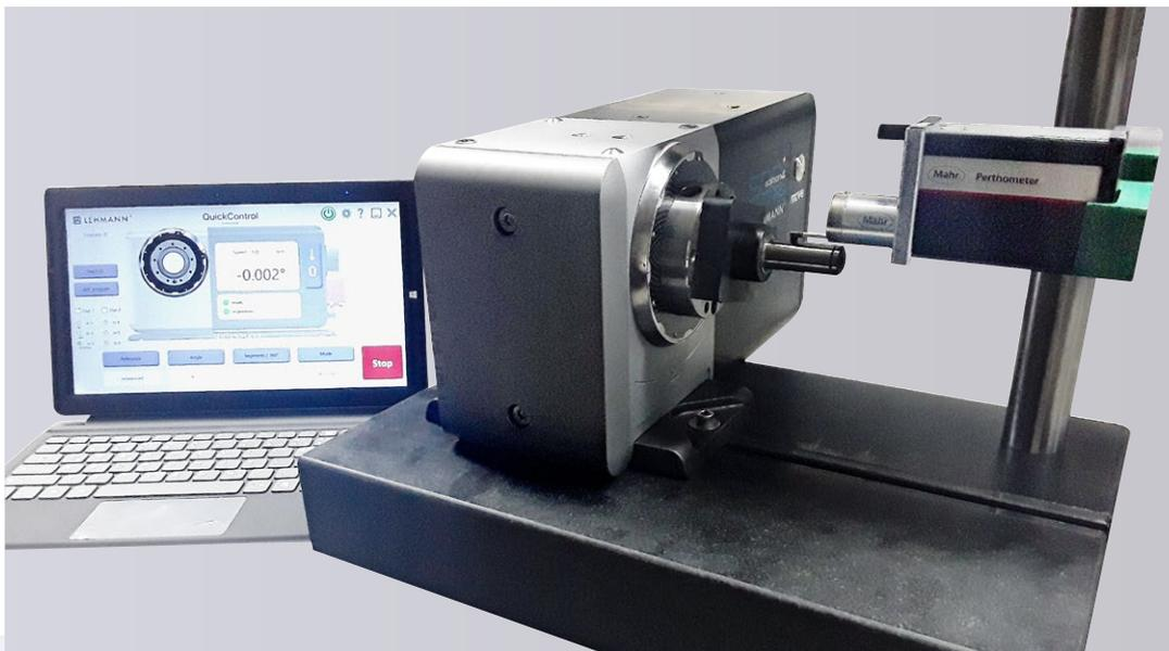
El sistema Q-Line de pL LEHMANN también puede usarse para la medición de contornos y de superficies de un eje.
