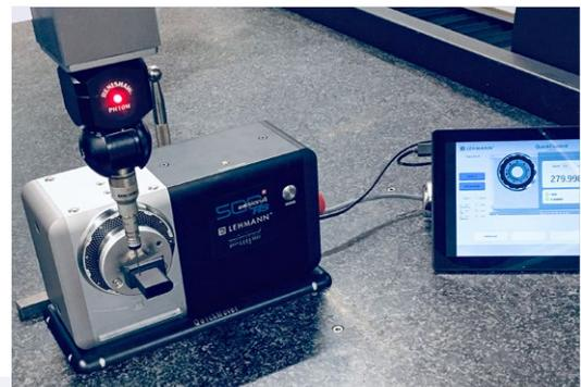
Q-Line en uso: medir un electrodo en un dispositivo de medición de coordenadas
