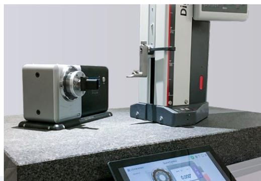
Uso del sistema Q-Line: Medición de ángulos y de paralelismos en un electrodo con un lugar de medición de granito con medidor de altura
