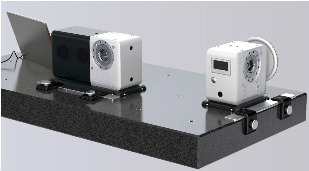
Con el sistema de punto cero QuickBar, se pueden ubicar todas las mesas giratorias, equipadas con el sistema QuickMover (cojín de aire) de manera rápida y precisa en posición de medición. QuickBar está disponible tanto para el montaje en el borde como también en la superficie. Debido a cojines autoadhesivos, no es necesario taladrar orificios. QuickBar también puede montarse en una trama de 200 o de 300 mm.
