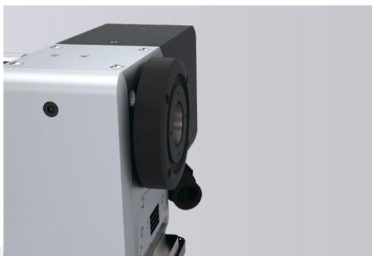
La longueur de la structure du système de mesure angulaire ultra-compact pour la série M-Line, ici sur une table rotative à un seul axe EA-510, est seulement de 30 mm. Elle permet d'atteindre des précisions de positionnement jusqu'à  $\pm 2,5''$ .
