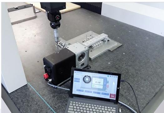
Q-Line sur KMM : mesurer des angles, des rainures, des surfaces et des perçages sur des dispositifs de serrage complexes
