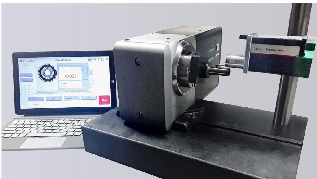
La table Q-Line de pL LEHMANN peut également être utilisée pour la mesure des contours et de la surface d'un arbre.
