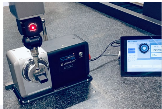
Q-Line in uso: misurazione di un elettrodo su una macchina di misura a coordinate
