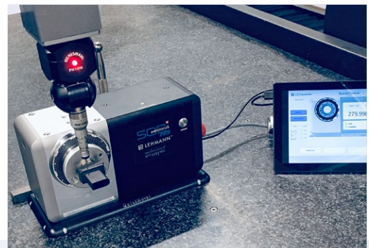
Q-Lineの動作：三次元測定機での電極の測定
