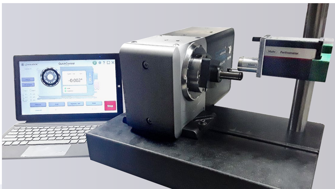
pL LEHMANNのQ-Lineは、シャフトの輪郭と表面を測定するためにも使用できます。
