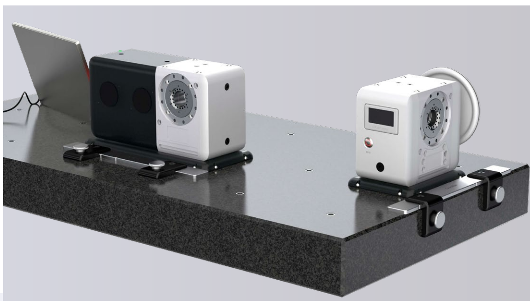
Благодаря системе с нулевой точкой QuickBar можно быстро и точно перевести все поворотные столы, оснащенные пластиной QuickMover (воздушная подушка), в положение для измерения. Упор QuickBar можно устанавливать как на край, так и на плоскую поверхность. Благодаря клеевым пластинам не нужно просверливать дополнительные отверстия. Для QuickBar также можно использовать перфорированные рейки 200 или 300 мм.
