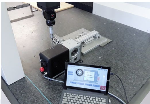
Линейка Q для КММ: измерение углов, пазов, поверхностей и отверстий в комплексных натяжных устройствах
