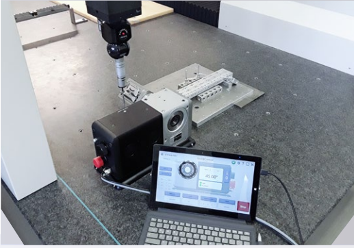
Q-Line KMM üzerinde: Karmaşık bağlama ekipmanı üzerinde aç, kanal, yüzey ve delik ölçümü
