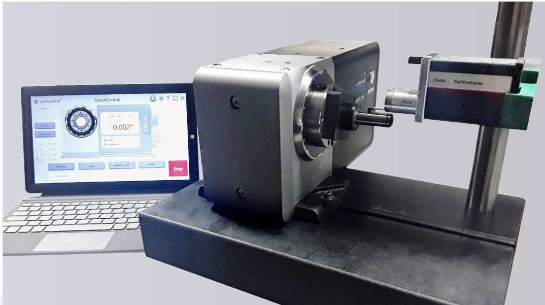
pL LEHMANN Q-Line, bir milin kontur ve yüzey ölçümü için de kullanılabilir.
