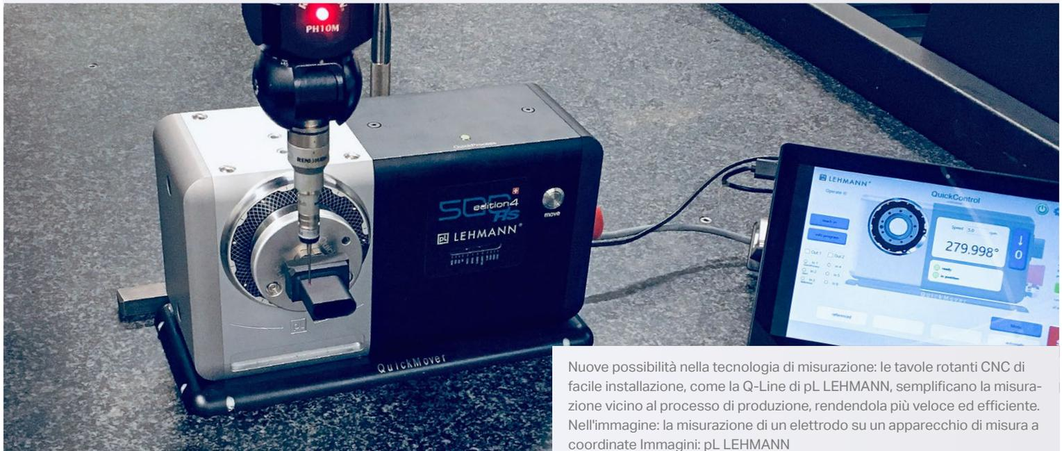
Nuove possibilità nella tecnologia di misurazione: le tavole rotanti CNC di facile installazione, come la Q-Line di pL LEHMANN, semplificano la misurazione vicino al processo di produzione, rendendola più veloce ed efficiente. Nell'immagine: la misurazione di un elettrodo su un apparecchio di misura a coordinate Immagini: pL LEHMANN
