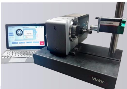
Q-Line di pL LEHMANN può essere utilizzata anche per la misurazione del contorno e della superficie di un albero.
