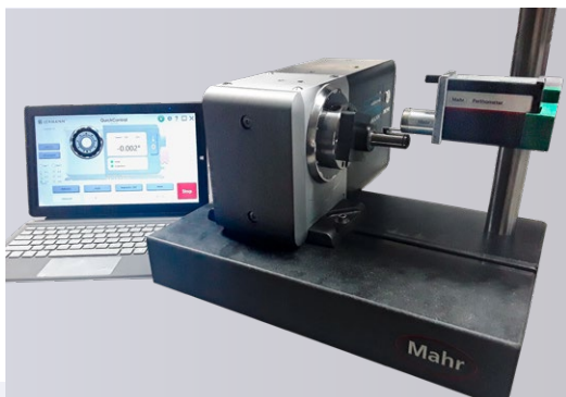
pL LEHMANNのQ-Lineは、シャフトの輪郭と表面を測定するためにも使用できます。
