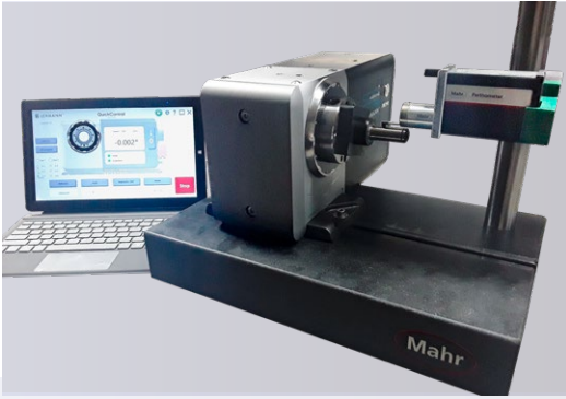
pL LEHMANN Q-Line, bir milin kontur ve yüzey ölçümü için de kullanılabilir.
