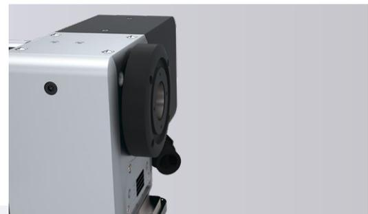
La longitud de montaje del sistema de medición angular ultracompacto del sistema M-Line, aquí visualizado en una mesa giratoria de un solo eje EA-510, mide tan solo 30 mm. Alcanza una precisión de posicionamiento de hasta  $\pm 2.5''$ .
