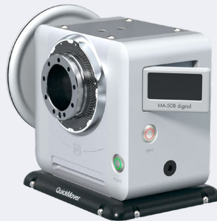
Das Einstiegsmodell der Q-Line von pL LEHMANN: der manuelle, superflexible Drehtisch MA-508.m Q. Unter dem Drehtisch ist die Adapterplatte QuickMover zu sehen, links das Handrad, rechts die Digitalanzeige. Bilder: pL LEHMANN
