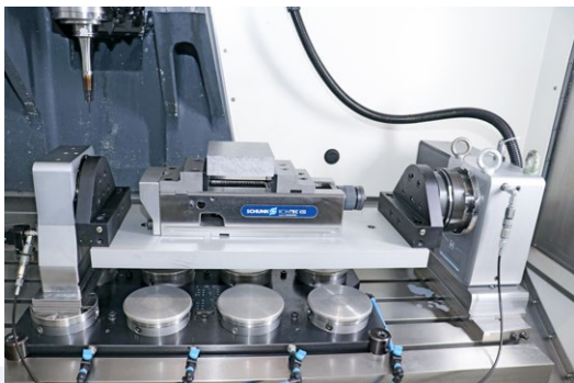
Der pL LEHMANN CNC-Drehtisch EA-520 lässt sich mit einer Spannbrücke rotoFIX ergänzen, die wiederum mit verschiedenen Spannmitteln ausgestattet sein kann.
