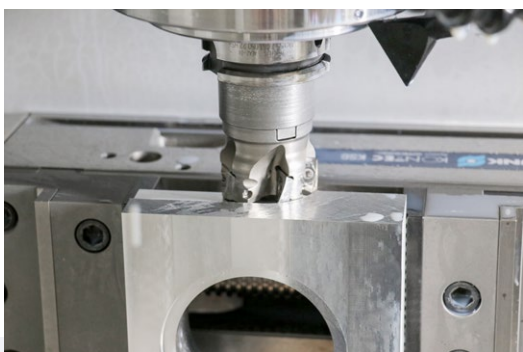
La table rotative pL EA-520.L-M1 est parfaitement adaptée à la machine en termes de puissance d'entraînement, de forces de serrage et de précision. Elle permet également des usinages plus lourds.
