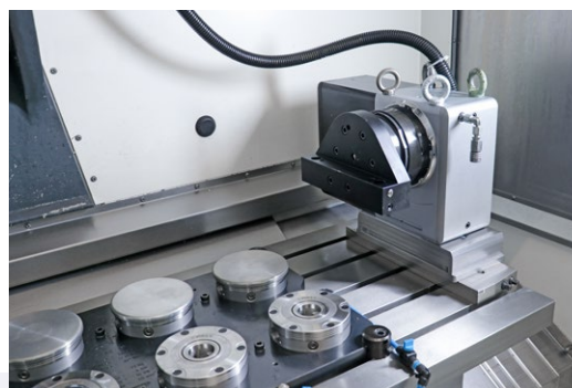
Avec une force de serrage de 20 kN, le dispositif de serrage à point zéro gredoc convient parfaitement à la broche en acier de la table rotative - ici avec la joue d'adaptateur serrée pour la bride de serrage rotoFIX. Un passage rapide au mandrin à trois mors est garanti.
