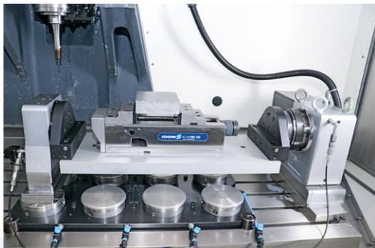
La tavola rotante CNC EA-520 di pL LEHMANN può essere completata da un ponte di serraggio rotoFIX, che a sua volta può essere equipaggiato con diversi dispositivi di serraggio.
