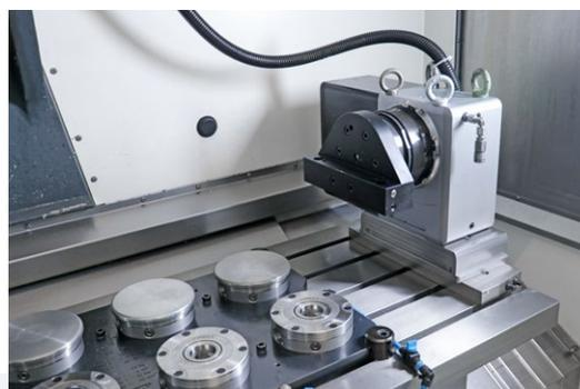
Con una forza di trazione di 20 kN, il dispositivo di serraggio a punto zero gredec è perfetto per il mandrino della tavola rotante – qui con l'adattatore per il ponte di serraggio rotoFIX. Il passaggio rapido al mandrino a tre griffe è garantito.
