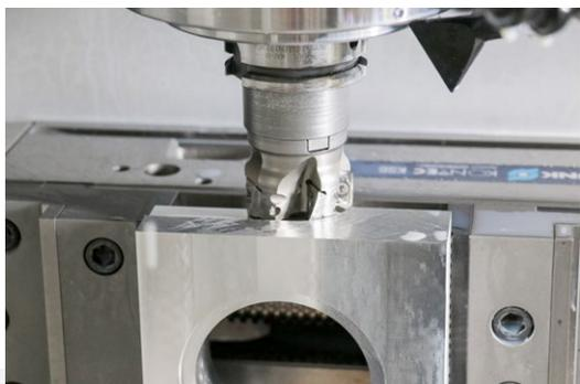
La tavola rotante pL EA-520.L-M1 è perfetta per la macchina in termini di potenza motrice, forze di serraggio e precisione. Permette inoltre di eseguire anche lavorazioni più pesanti.
