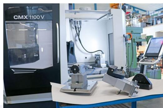
Il nuovo acquisto di AlTech: il centro di foratura e fresatura a tre assi DMG MORI CMX 1100V, completato dalla tavola rotante CNC EA-520 di pL LEHMANN e da numerosi accessori (in primo piano si vedono la contropunta traslabile, l'adattatore per il ponte di serraggio, il suo controsupporto e il mandrino a tre griffe montabile con il sistema di serraggio a punto zero gredoc).
