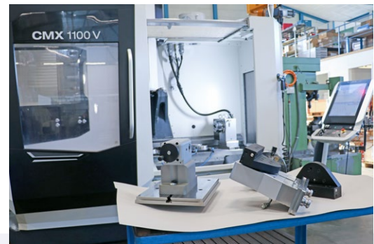
Nuevo en AITech: el centro de taladrado y fresado DMG MORI CMX 1100V, ampliado por la mesa giratoria CNC EA-520 de pL LEHMANN y múltiples accesorios (en la imagen se puede observar el cabezal móvil desplegable, el adaptador para el perforar, sus contracojinetes y el mandril de tres mordazas que se puede montar mediante el tensor de punto cero gredoc).
