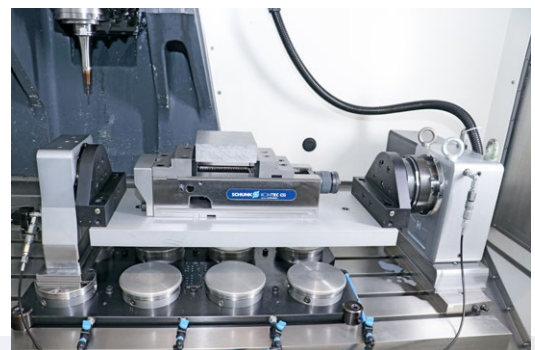
pL LEHMANN EA-520 数控转台可以配备一个 rotoFIX 卡板，而该卡板又可以配备各种夹持装置。
