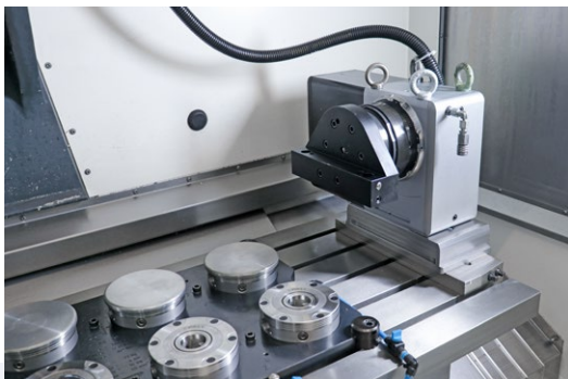
gredoc 零点夹具具有 20 kN 的拉力，完全适用于转台的主轴，这里夹持有用于 rotoFIX 卡板的适配器板。这保证了操作员可以快速更换为三爪卡盘。
