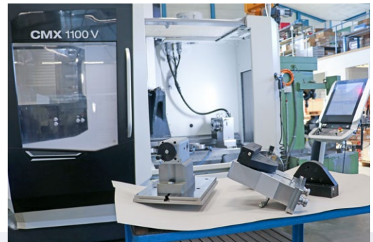
AITech 的新产品：DMG MORI CMX 1100V 三轴钻铣中心，辅以 pL LEHMANN EA-520 数控转台和各种附件（在前景中可以看到可移动的尾座、用于卡板的适配器板、其止推轴承和可通过 gredoc 零点夹持系统安装的三爪卡盘）。
