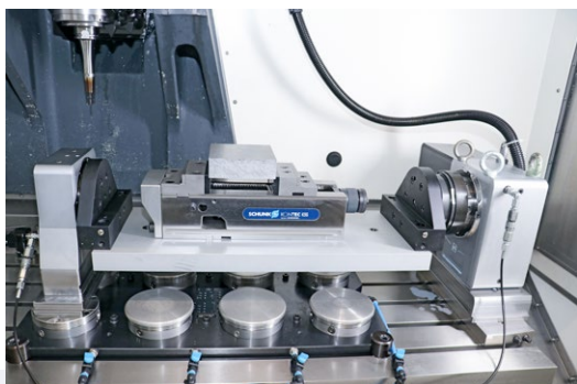
pL LEHMANN CNCターンテーブルEA-520にはクランプブリッジrotoFIXを追加できます。これにはさまざまなクランプを取り付けることができます。
