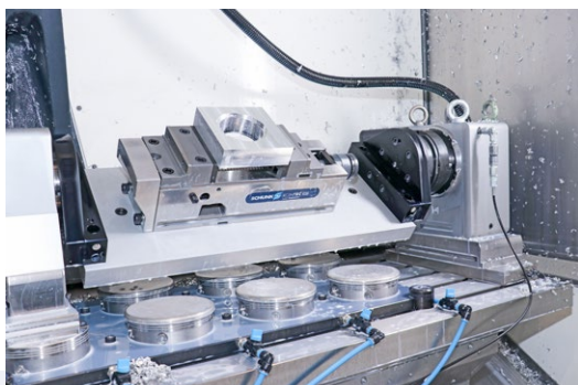
高い柔軟性と短いセットアップ時間の鍵：Schunk社とGressel社のゼロポイントクランプシステムと組合せ、機械テーブルの右端に取り付けられたpL LEHMANN CNCターンテーブルEA-520（ここではクランプブリッジrotroFIX付き）。
