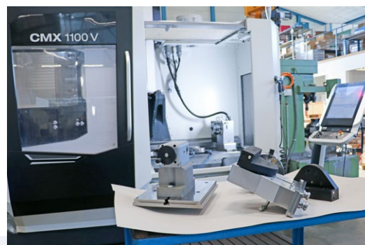
AITech社の新機能：3軸マシニングセンタDMG MORI CMX 1100V、pL LEHMANN CNCターンテーブルEA-520やさまざまな付属品を追加（前面には可動テールストック、クランプブリッジ用アダプターク、そのカウンタベアリングおよびgredocゼロポイントクランプシステムにより取り付け可能な3爪チャックがあります）。
