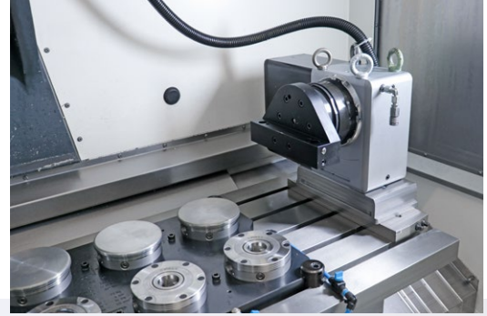
20 kN çekiş gücüne sahip gredoc sıfır nokta bağlama sistemi döner tablanın iş mili için mükemmel derecede uygundur - burada rtpFIX gergi köprüsünün bağlanmış adaptör çenesiyle görülmektedir. Üç çeneli torna aynasına çabucak geçiş garantidir.
