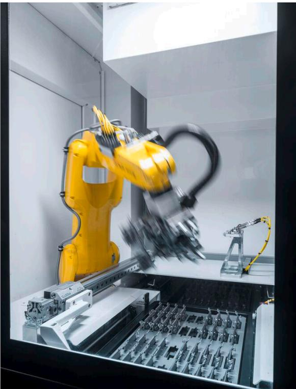
Der Werkstückspeicher des WH 3 an der DMP 70 bietet Platz für bis zu 600 Werkstücke und ermöglicht damit die mannlose Fertigung von bis zu 15 h. (Bild: DMG MORI / Griesshaber)
