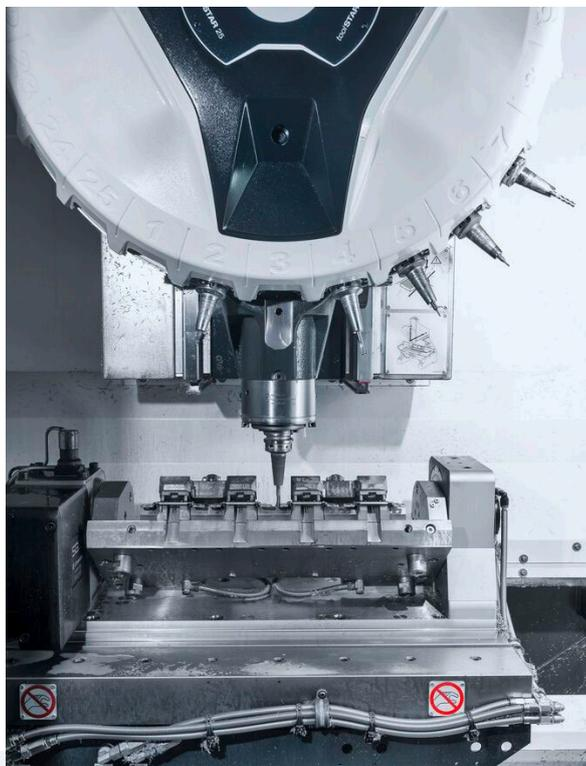
Die Spannvorrichtung wurde speziell für diesen Prozess ausgelegt und bietet Platz für 4 Werkstücke. (Bild: DMG MORI / Griesshaber)
