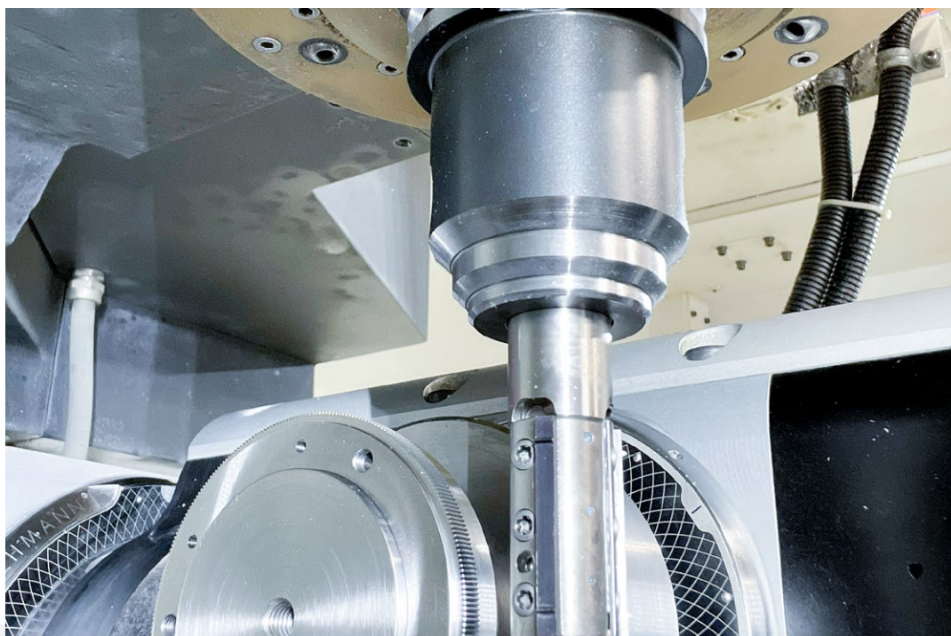
Cette roue codeuse comprend des centaines de dents qui, grâce à un capteur électrique placé à l'intérieur d'une broche Fischer, encodent la position de rotation de la tige de broche ainsi que sa vitesse. Lors de l'usinage de ces pièces, la précision radiale et axiale du plateau pL LEHMANN, ainsi que sa rigidité, sont primordiales pour fraiser avec précision ces dents d'engrenage sur le centre d'usinage vertical Mazak.
