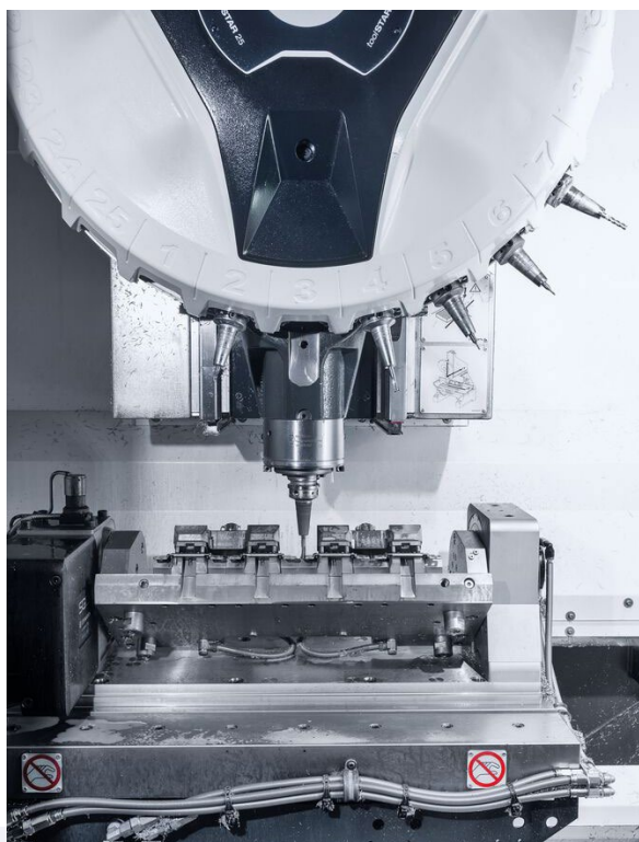
Le dispositif de serrage a été spécialement conçu pour ce processus et peut loger 4 pièces. (Photo : DMG MORI / Grißhaber)
