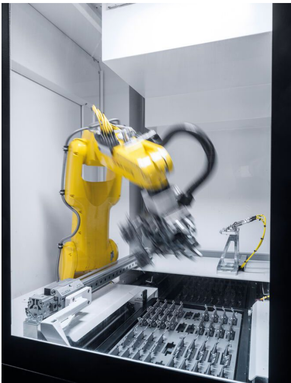
Le magasin de pièces du WH 3 sur le DMP 70 accueille jusqu'à 600 pièces, rendant ainsi possible une fabrication sans opérateur pendant 15 heures. (Photo : DMG MORI / Griesshaber)
