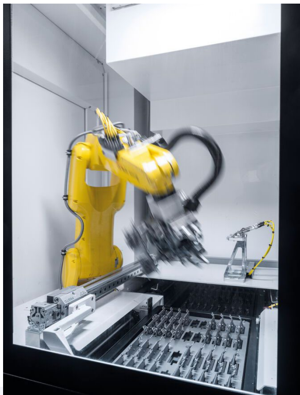
Il magazzino pezzi della WH 3 sulla DMP 70 offre spazio per un massimo di 600 pezzi e consente quindi una produzione non presidiata fino a 15 ore. (foto: DMG MORI / Griëßhaber)
