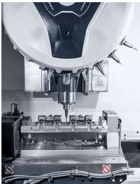
El dispositivo tensor ha sido diseñado especialmente para este proceso y ofrece espacio para 4 piezas. (Imagen: DMG MORI / Griesshaber)
