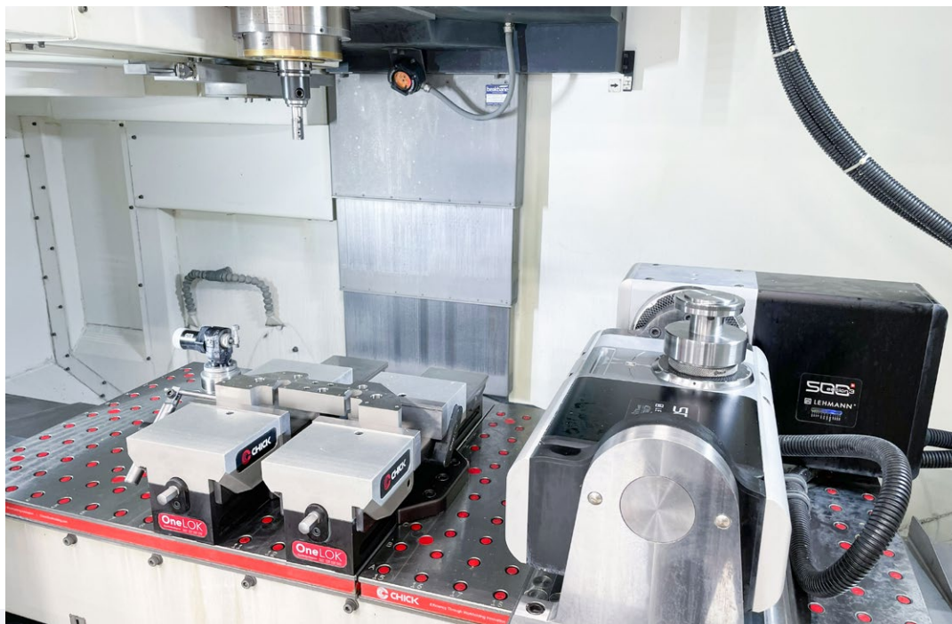
在 Mazak VMC 上，安装通常包括工作台左侧 Chick 或 Lang 牌虎钳夹持的零件，以及右侧 pL LEHMANN 双轴转台托持的零件。Fischer USA 团队设计的巧妙的工件夹具解决方案可借助工作台 180 度翻转零件的能力，翻转放置于 pL LEHMANN 转台的零件，同时在两侧径向和轴向对零件进行加工。
