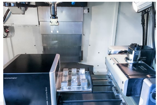
ROTOMATIONを使用して完全自動化した5軸マシニングセンターは、少人数のシフトで部品の完全な加工を実現します。
