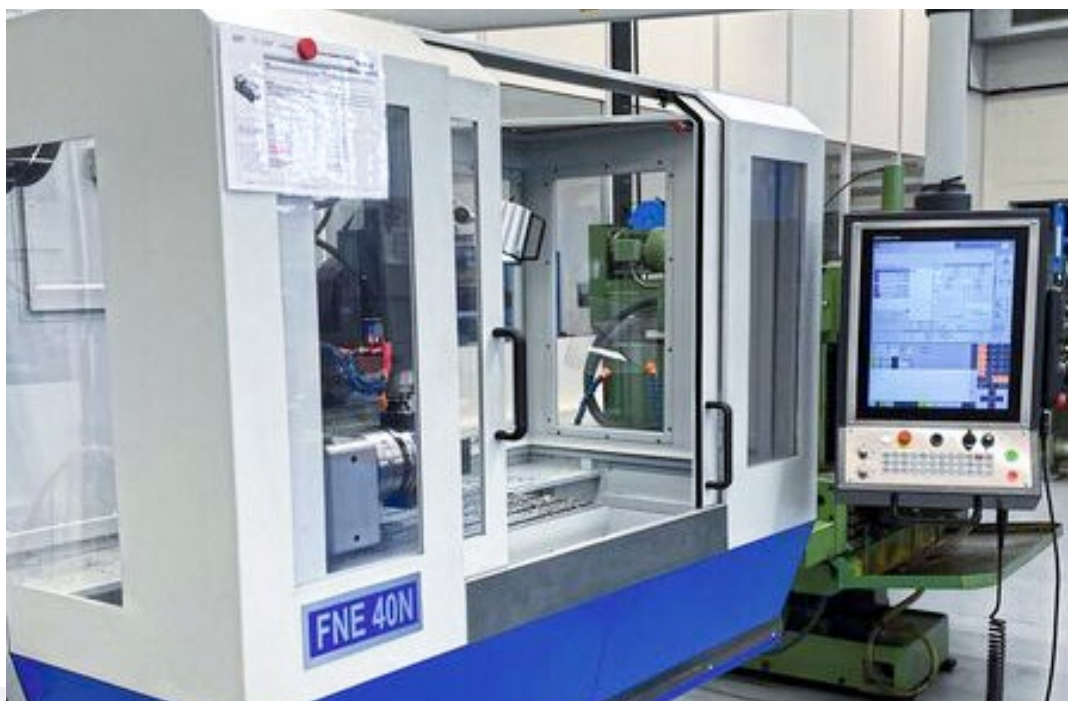
Die manuell und CNC-bedienbare Werkzeugfräsmaschine Avia FNE40 N ist mit einer modernen Heidenhain-Steuerung TNC620 HSCI ausgestattet.
