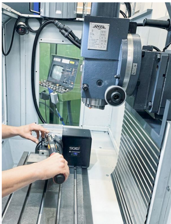
Die original 3-Achs- Maschine von Avia ist mit einem Teileapparat EA-510-M3 von Peter Lehmann ausgestattet. Das ermöglicht eine 4-Achs-Simultanbear- beitung mit der Programmierung von Hypermill.
