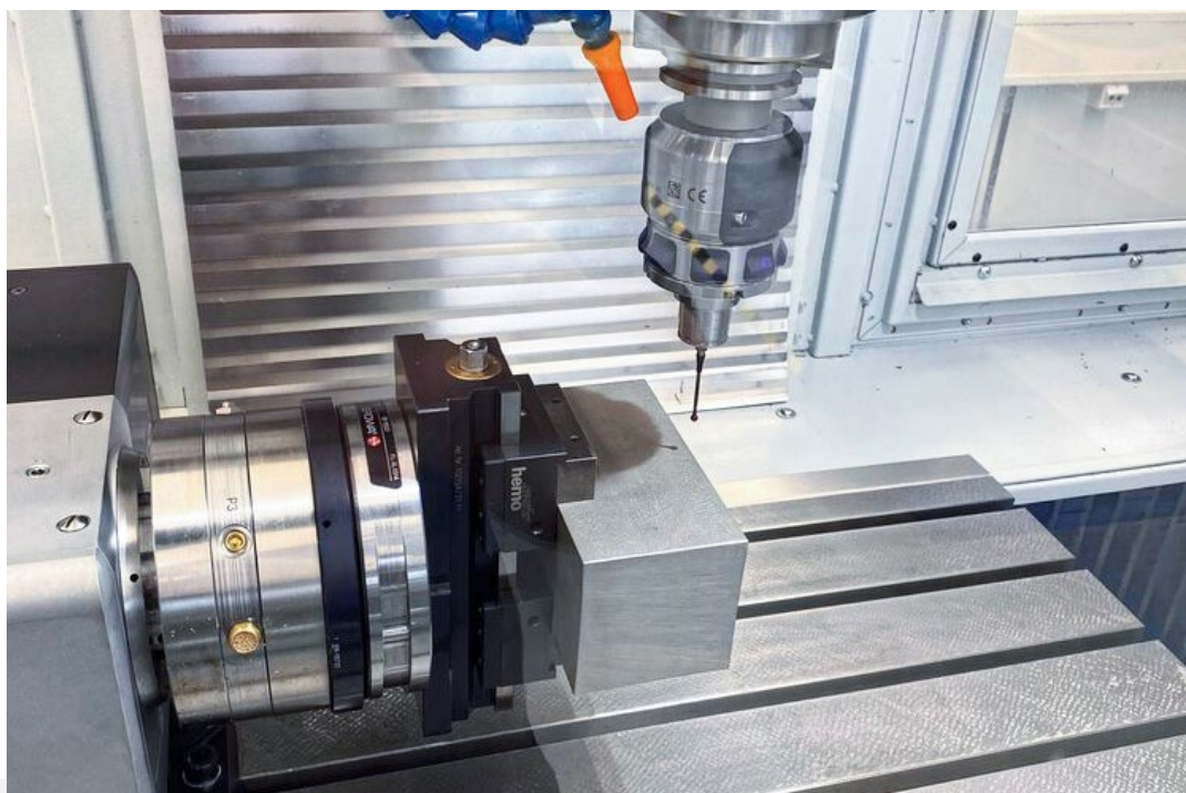
Innenansicht der Avia FNE40 N: Die Maschine ist mit gross dimensionierten Flachführungen ausgestattet. Im Bild zu sehen ist die Vermessung des Bauteils mit dem Messtaster von Heidenhain TS460.
