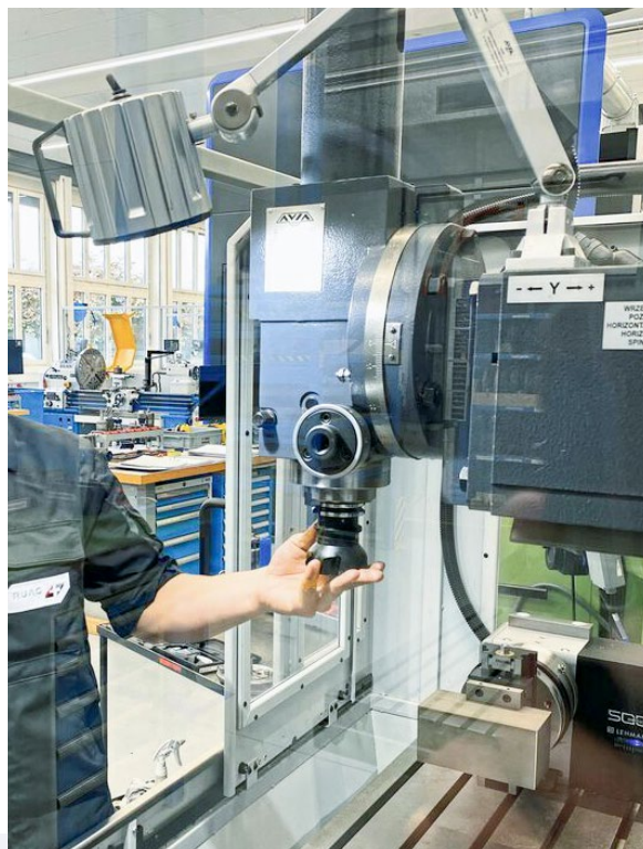
Die neue Avia-Maschine ist mit einem hydraulisch betätigten Werkzeug-Entspannsystem für Werkzeughalter SK40 69871 A ausgerüstet.
