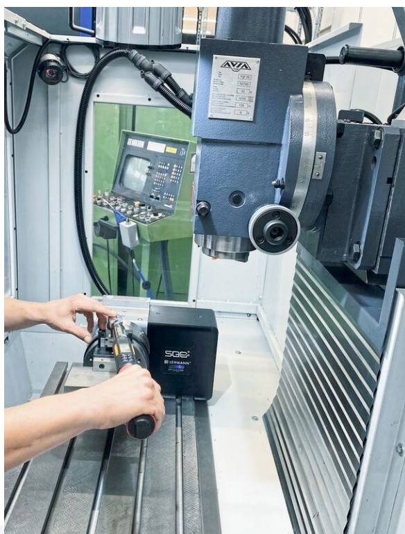
La machine 3 axes originale d'Avia est équipée d'une table rotative EA-510-M3 de Peter Lehmann. Elle permet de réaliser un usinage simultané 4 axes avec la programmation d'Hypermill.
