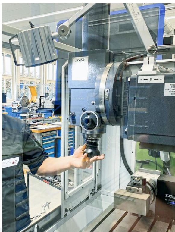
La nuova macchina Avia è dotata di un sistema di sblocco utensili ad azionamento idraulico per i portautensili SK40 69871 A.
