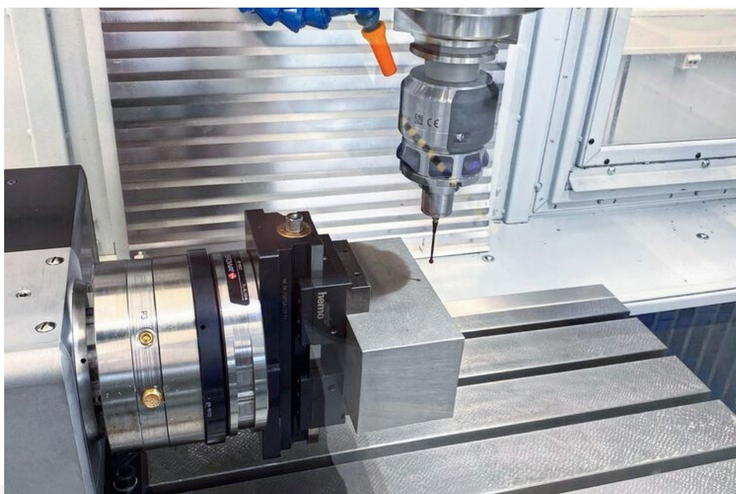
Vista interna della macchina Avia FNE40 N: La macchina è dotata di guide piane di grandi dimensioni. L'immagine mostra la misurazione del componente con il sensore di misura Heidenhain TS460.
