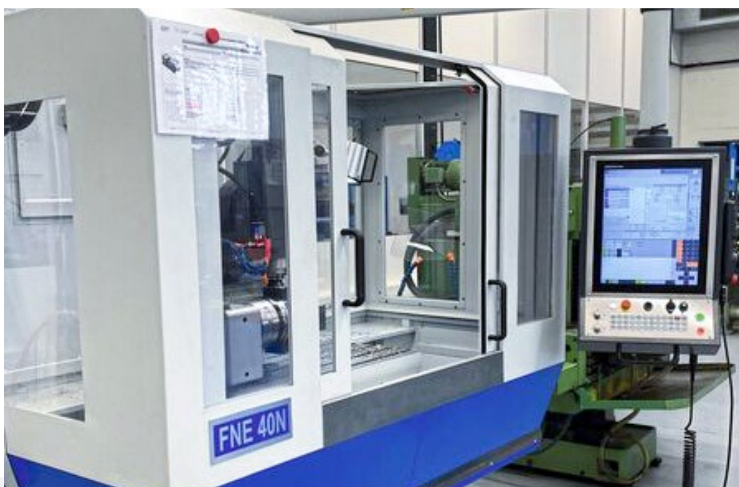
La fresadora de manejo manual y a través de CNC Avia FNE40 N equipa un moderno sistema de control Heidenhain TNC620 HSCI.
