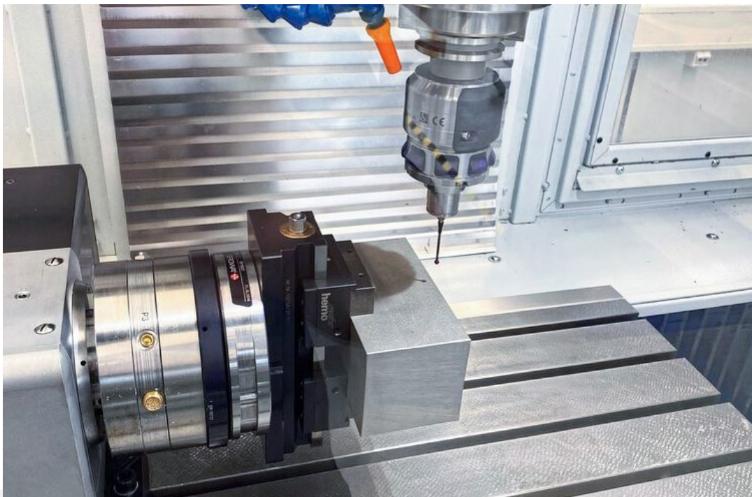
Avia FNE40 N 内视图：机床配备有大尺寸平导轨。图中展示了用 Heidenhain TS460 测头对部件进行测量。
