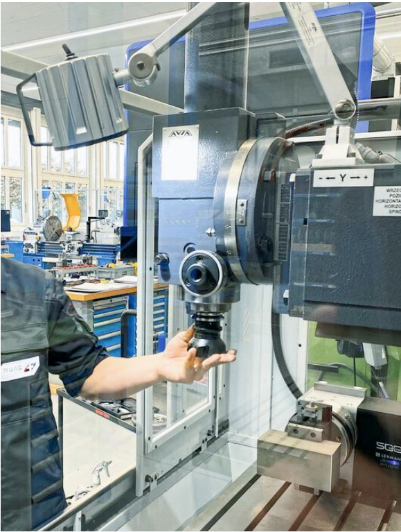
新 Avia 机床配备了用于刀架 SK40 69871 A 的液压致动刀具释放系统。
