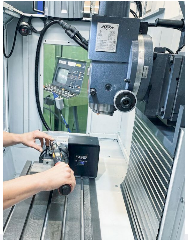
原装 Avia 3 轴机床配备了一个 Peter Lehmann 公司的 EA-510-M3 转台。其作用是实现 4 轴联动加工，并可以对 Hypermill 进行编程。
