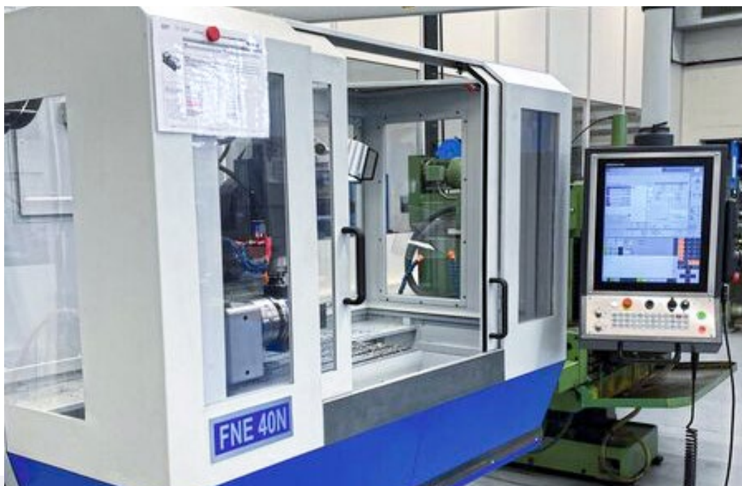
手动和数控操作的 Avia FNE40 N 铣床配备了 TNC620 HSCI 型现代 Heidenhain 控制系统。
