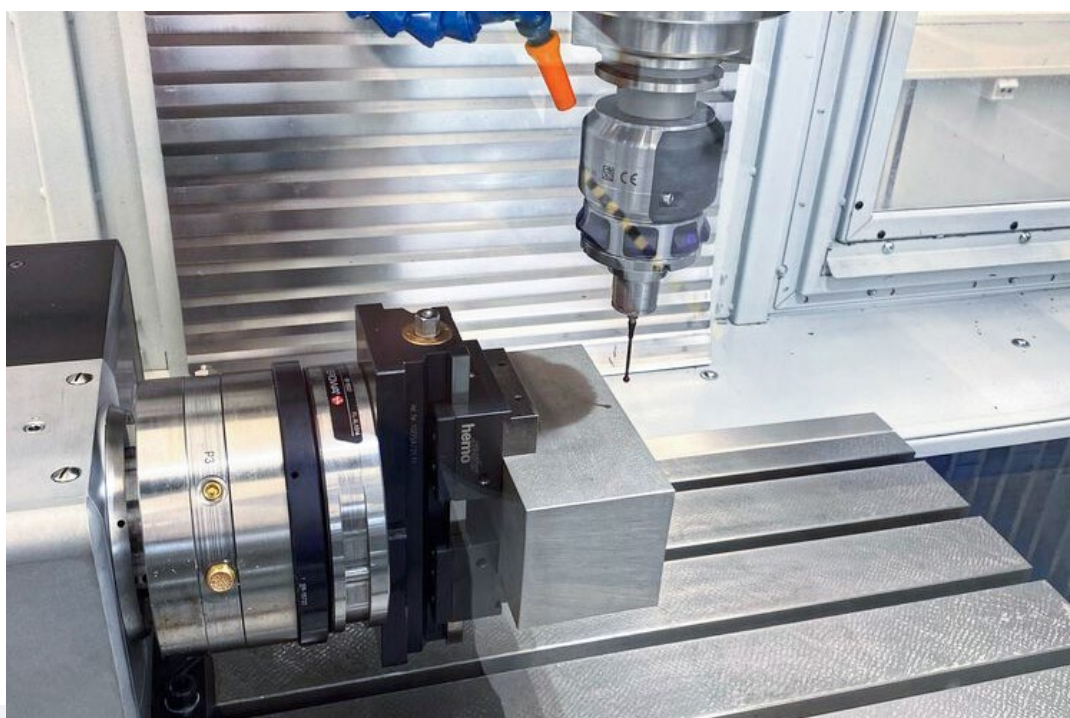
Avia FNE40 Nの内容: この機械は大型サイズのフラットガイドを装備しています。写真にあるようにコンポーネントの計測はHeidenhain TS460測定プローブで行います。
