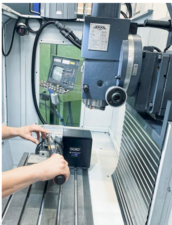
Avia独自の3軸機はピーター・レーマンのターンテーブルEA-510-M3を装備しています。これでハイパーミルのプログラミングによる4軸同時加工が可能になります。
