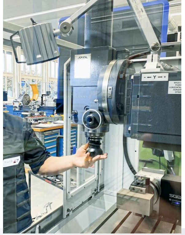
Yeni Avia makine, SK40 69871 A takım tutucular için hidrolik olarak çalıştırılan bir takım çözme sistemi ile donatılmıştır.
