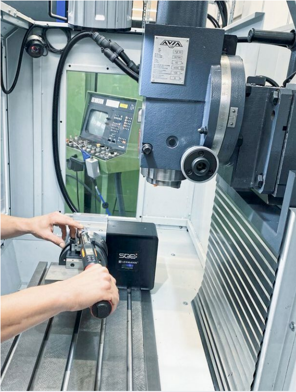
Avia'nın orijinal 3 eksenli makinesi, bir Peter Lehmann EA-510-M3 döner tabla ile donatıldı. Bu sayede, Hypermill programlama ile 4 eksenli eşzamanlı işlemeye olanak sağlanıyor.
