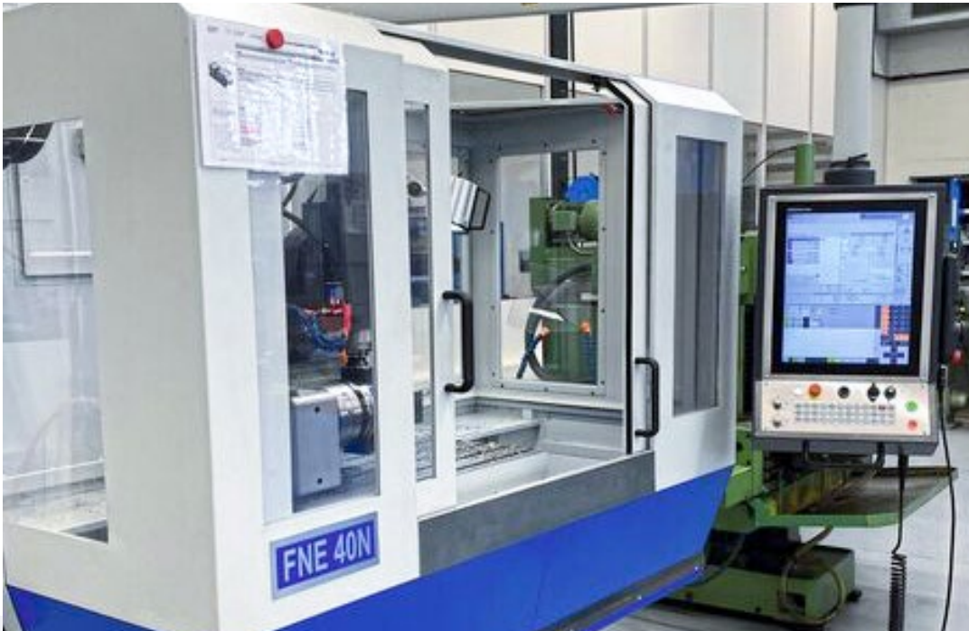
Manuel ve CNC ile kullanılabilen Avia FNE40 N takım freze makinesi, modern bir Heidenhain TNC620 HSCI kumanda ile donatılmıştır.
