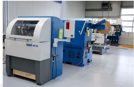
ISELI liefert Schärfausstattung für die Bearbeitung von Bandsägen, Gattersägen, Kreissägen und Messer – in Schweizer Präzision und Qualität.
