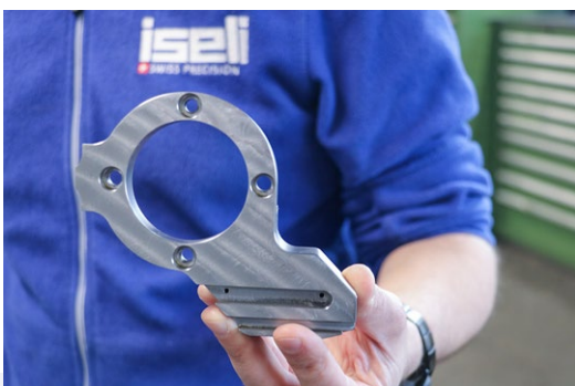
ISELI fertigt die für seine Maschinen benötigten Komponenten selbst. Dieses beispielhafte Bauteile wurde auf der automatisierten Makino PS105 mit pL-Drehtisch komplett bearbeitet.
