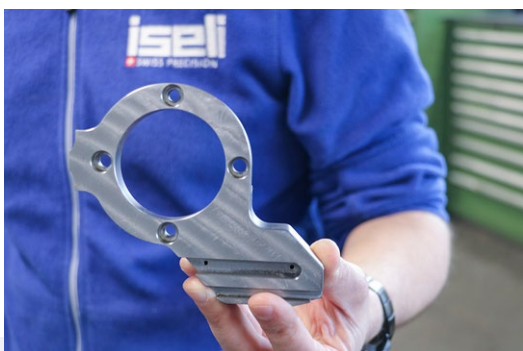
I SELI produce in proprio i componenti necessari per le proprie macchine. Questo componente di esempio è stato lavorato completamente sulla tavola rotante Makino PS105 automatizzata.
