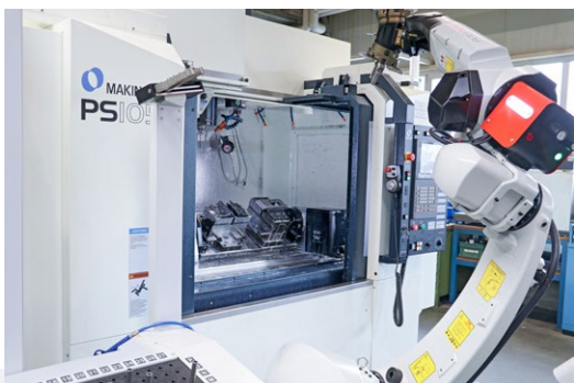
狭い空間で高生産性 - ISELIに設置された3+1軸方式マシニングセルは段取りが容易で、プロセスが安全なオートメーション操業に納得できます。
