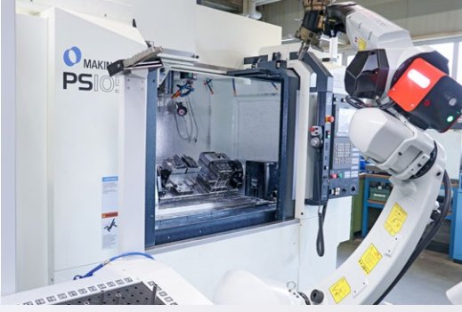
Dar alanda yüksek verimlilik - Iseli'de kurulan 3+1 eksenli üretim hüccesinin kurulumu kolay ve proses açısından güvenli otomatik çalışmayla etkileyici.
