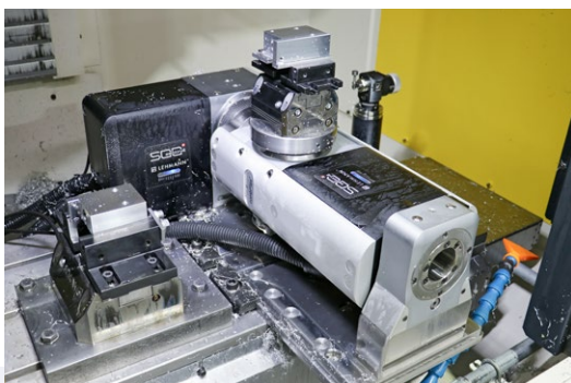
El diseño compacto de la mesa giratoria pL, todavía queda espacio en el área de procesamiento de la Fanuc Robodrill para un dispositivo de sujeción adicional para el procesamiento del lado posterior
