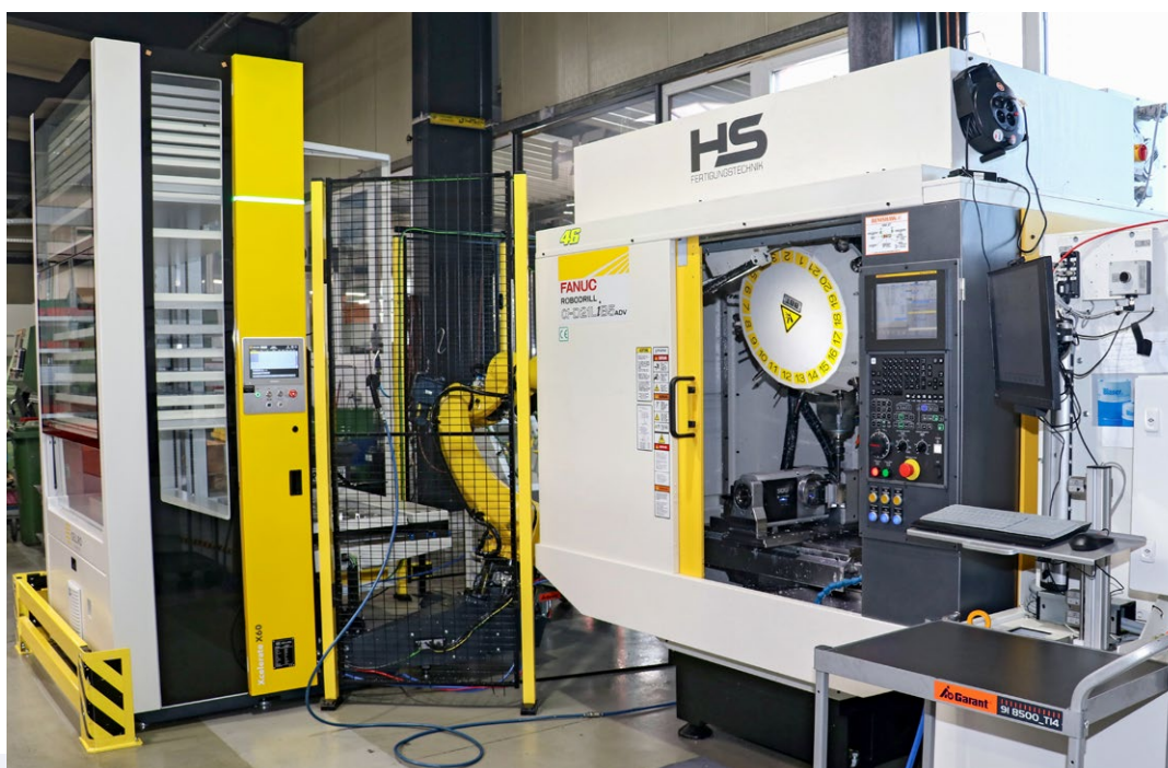
Con la mesa giratoria de dos ejes pL LEHMANN T1-507510.LL, la fresadora de 3 ejes Fanuc Robodrill α-D21MiB5ADV se convierte en un centro de mecanizado compacto de 5 ejes.
