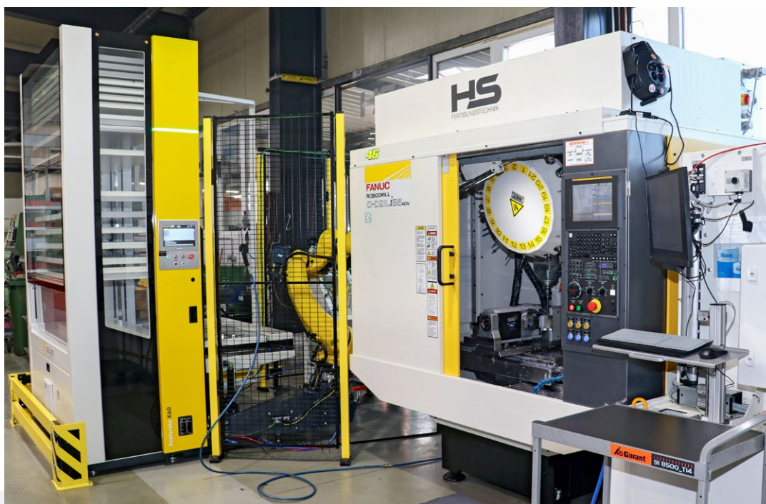
在 pL LEHMANN 的 T1-507510.LL 型两轴转台的加持下，让 \alpha -D21MiB5ADV 型三轴铣床 Fanuc Robodrill 变成了一台结构紧凑的五轴加工中心。
