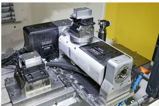
pL 转台结构紧凑，为 Fanuc Robodrill 的加工区提供了充足的空间，足以额外安放一台用于背面加工的夹具
