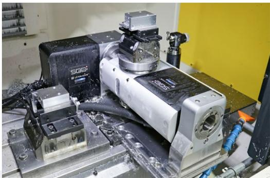
pL ターンテーブルはコンパクトな設計であるためファナックRobodrilの加工空間では裏面加工用の追加的クランプ装置用に十分なスペースが取れます。
