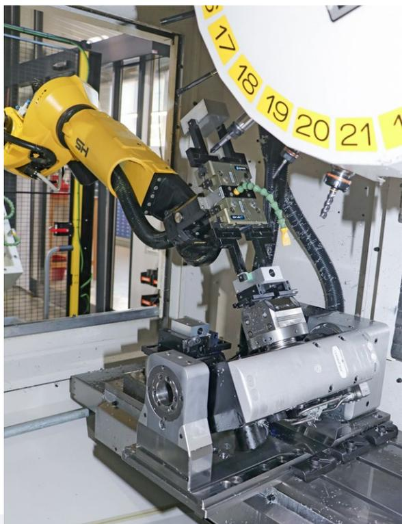
二重グリップ付きのこのロボットはpLターンテーブルにクランプ装置を乗せ、降ろすこともこなします。追加的にロボットがアラインメントや測定および洗浄作業もこなします。
