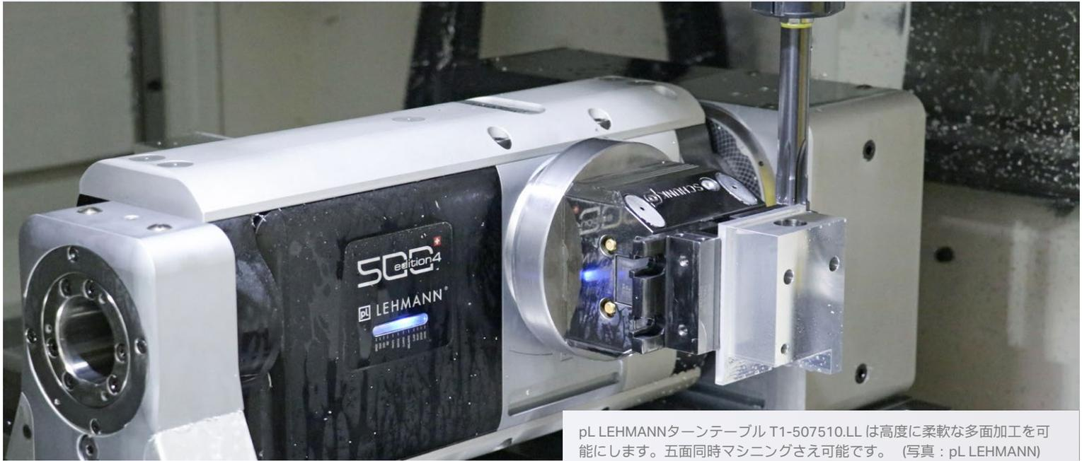
pL LEHMANNターンテーブル T1-507510.LL は高度に柔軟な多面加工を可能にします。五面同時マシニングさえ可能です。(写真：pL LEHMANN)
