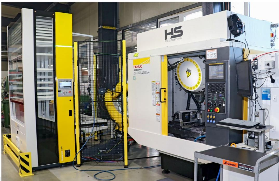
二軸pL LEHMANNターンテーブル T1-507510.LLで3軸フライス加工機ファナックRobodril α-D21MiB5ADVはコンパクトな5軸マシニングセンターになります。
