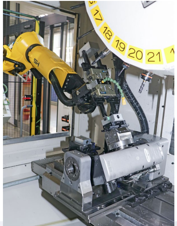
Çift kavrayıcı robot, pL döner tabla üzerindeki bağlama tertibatını yüklüyor ve boşaltıyor. Ek olarak hizalama, ölçüm ve temizlik görevlerini de üstleniyor.
