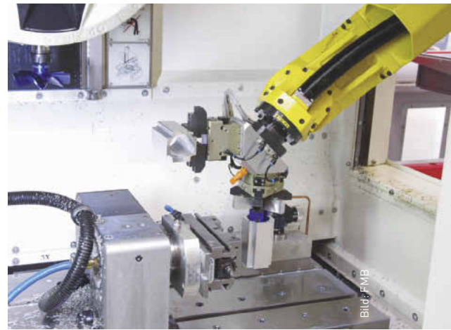
Der Fanuc-Roboter wechselt mit seinem Doppelgreifer Roh- und Fertigteile in der Spannvorrichtung des Bohr-Fräszentrums
