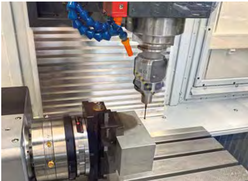
Innenansicht der Avia FNE40 N: Die Maschine ist mit gross dimensionierten Flachführungen ausgestattet. Im Bild zu sehen ist die Vermessung des Bauteils mit dem Messtaster von Heidenhain TS460.
