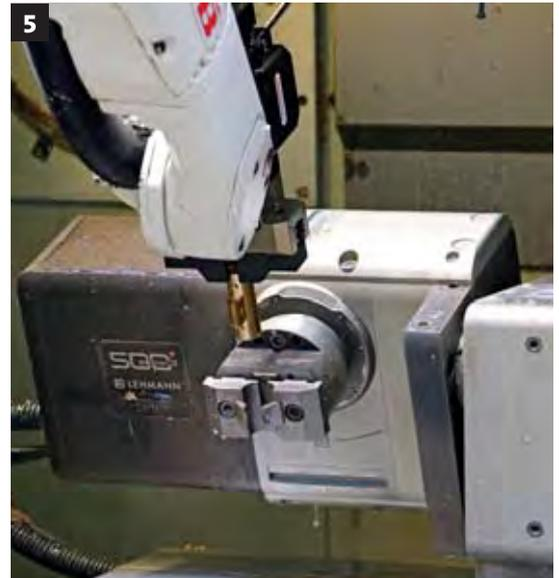
6 Dieses Bearbeitungszentrum Mori Seiki NVX5100 statete Werder nachträglich mit einem neuen, zweispindligen CNC-Drehtisch T2-510520.LR fix-F1-220 aus, der sich durch hohe Zuverlässigkeit, Geschwindigkeit, Haltemomente und Präzision auszeichnet.
