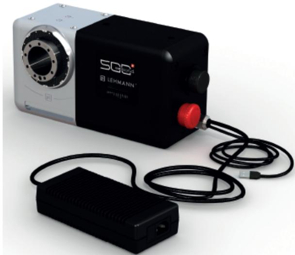
**Bild 2:** Der CNC-Drehtisch EA-508 light (in Komplettausstattung nur ca. 12 kg) von pL LEHMANN ist mit einer universellen Schnittstelle mit HSK A63 ausgestattet. Optional stehen Adapter für eine Spannzange ER20 oder diverse Schnellspannsysteme zur Verfügung. Zudem verfügt der Drehtisch über einen USB-Slot für Datenausgabe oder PC-Anschluss (oder Bluetooth), einen NOT-AUS-Schalter und ein Netzteil zum Anschluss ans 230V-Netz (Werkbilder: Peter Lehmann AG, CH-Bärau)
