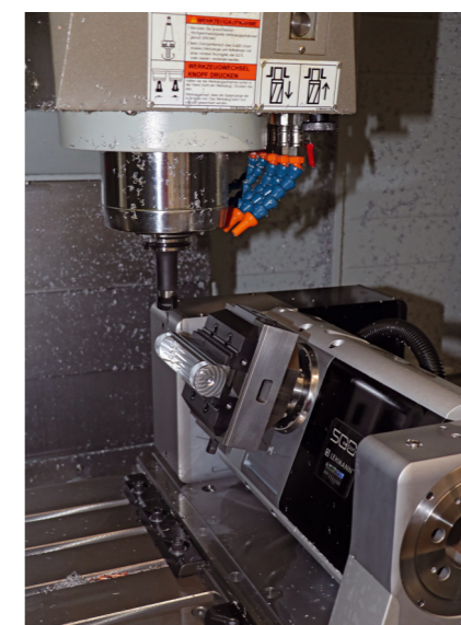
2 Zurzeit lastet Orlik die Maschine mit dem Drehtisch zu 40 Prozent mit fünfachsiger Bearbeitung aus, bei der – ob angestellt oder simultan – jedes Teil in zwei Aufspannungen fertig bearbeitbar ist (© pL Lehmann)
