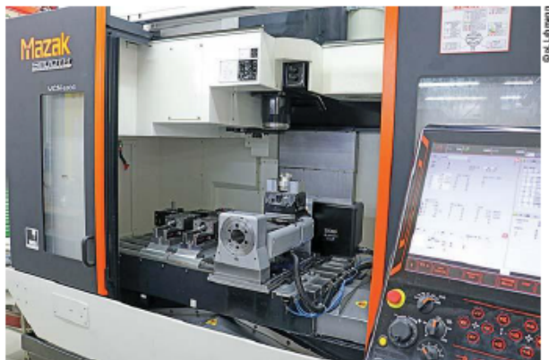
Centre d'usinage Mazak VCN 530C avec la table rotative CNC de pL Lehmann.
