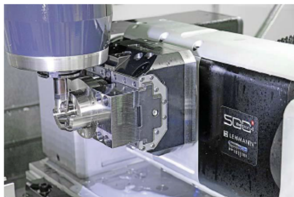
Le contre-palier fixé et les forces de maintien élevées permettent de serrer les pièces en acier inoxydable.
