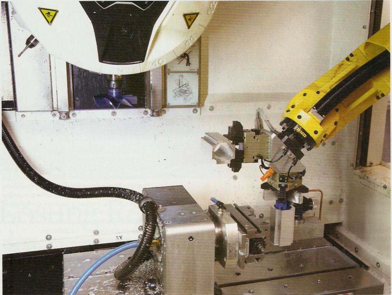
Der Roboter wechselt mit seinem Doppelgreifer Roh- und Fertigteile in der Spannvorrichtung des Bohr-Fräszentrums.
