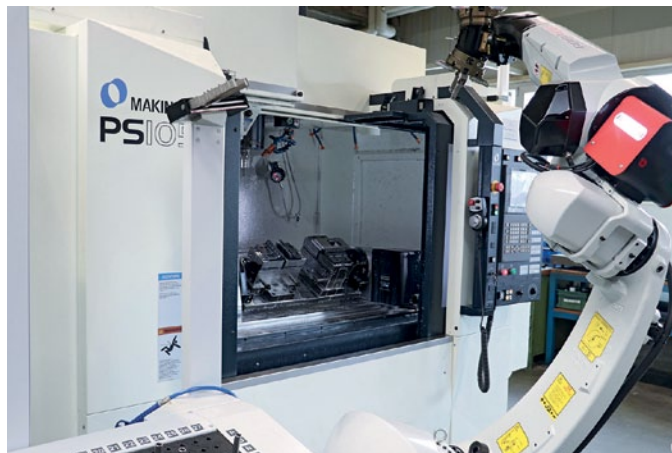
Hohe Produktivität auf kleinem Raum – die bei Iseli installierte 3+1-achsige Fertigungszelle ist einfach einzurichten und überzeugt durch prozesssicheren Automatikbetrieb. (Bild: pL Lehmann)
