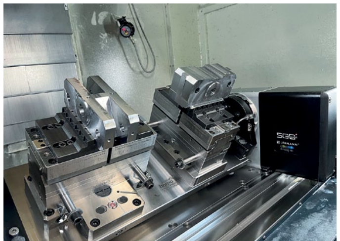
Der pL-Lehmann-Drehtisch «EA-520.R» macht aus der dreiachsigen «Makino PS105» ein 4-Achs-Bearbeitungszentrum, das sich in Verbindung mit der Spannvorrichtung und einem Roboter für eine vollautomatisierte 6-Seiten-Bearbeitung eignet. (Bild: Iseli)
