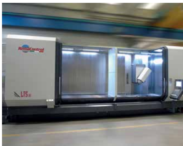
A sinistra: Raffaello, il centro di lavoro a 5 assi della Rema Control
